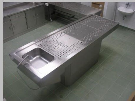
mit teilperforierter Arbeitsfläche, um Druckstellen zu vermeiden
