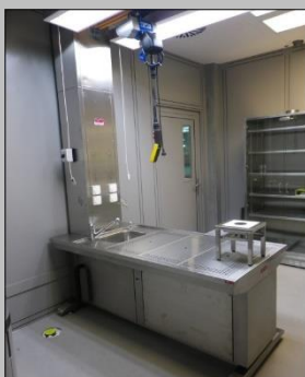
Tier-Sektionstisch mit Abluft und Kranbahn für optimale Kadaver- Positionierung
