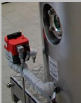
Beheizter Ausgang für Knochenfett seitlich der Anlage. Leicht zugänglich und effektiv
