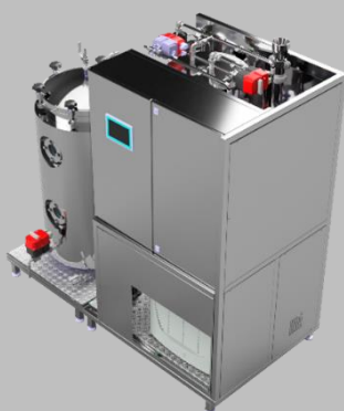
Knochenfett-Extraktionsanlage mit DCM-Rückgewinnungs- und Knochentrocknungs modul. Entfettungskammer: Ø 1000 mm x 1200 mm
