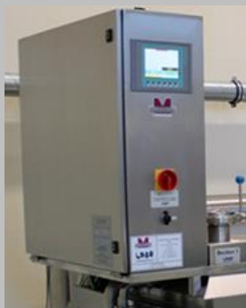
Touchscreen-Panel zur Programmierung. Texte in deutscher Sprache
