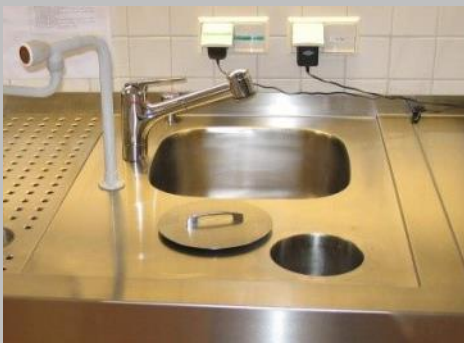
Beispiel: Manueller Formalin- Spender auf einer MEDIS Zuschneide-Station. Darunter der Ablauf in den Behälter für gebrauchtes Formalin
