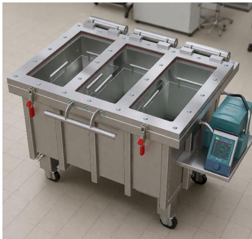
PEG-Imprägnierungsanlage zur Vakuum-Imprägnierung mit fest verbauter Vakuumpumpe.
